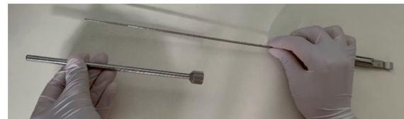
Skinite čep s kućištem vodilice s gumba s klizačem lijevo
