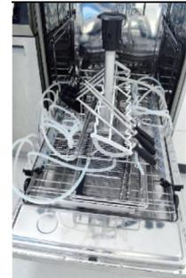
Laad bakken met de instrumenten op de daarvoor bestemde houders, in overeenstemming met de markeringen die zichtbaar zijn aan de onderkant van het deksel van de bak.
