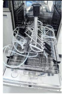
按照托盘盖下方的标记，将装有器械的托盘安放到专用支架上：
