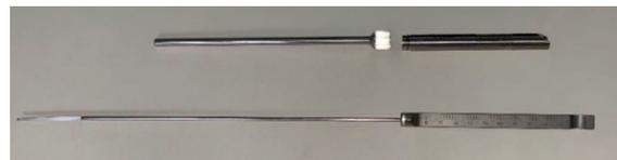
Jauge de profondeur pour manchons démontée
