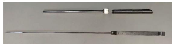
Dybdemåler for afmonterede muffer
