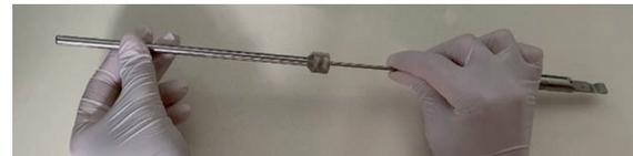
Schroef de kap met geleiderbehuizing los van de knop met schuif
