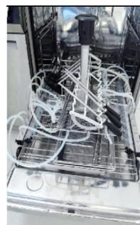
Ładować tace, układając narzędzia w dedykowanych miejscach, zgodnie z oznaczeniami widocznymi na dolnej części pokrywy tacy.
