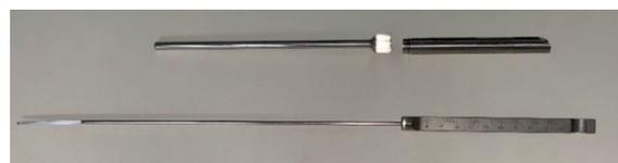
Medidor de profundidade para bainhas desmontadas
