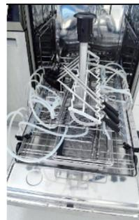
Ievietojiet paliktņus, novietojot instrumentus uz tiem paredzētajām statīva plāksnītēm, saskaņā ar marķējumu, kas redzams paliktņa vāka apakšējā pusē.
