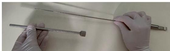
Отвийте наляво капачката с корпуса на водача от бутона с плъзгача
