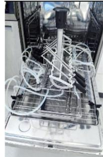
Cargue las bandejas colocando los instrumentos en los soportes correspondientes, siguiendo las marcas visibles en la parte inferior de la tapa de la bandeja.
