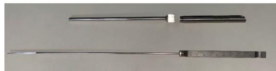
Αποσυναρμολογημένος μετρητής βάθους για περιβλήματα
