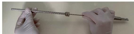
Kappe mit Führungsgehäuse von Taste mit Schieberegler abschrauben
