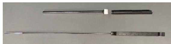
Tiefenmessgerät für Hüllen demontiert
