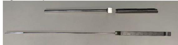
Kılıflar için derinlik ölçer, parçalarına ayrılmış
