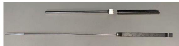
Dybdemåler for mansjetter demontert
