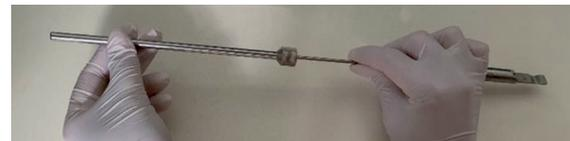
Desensrosque el tapón con carcasa para guía del botón con deslizador
