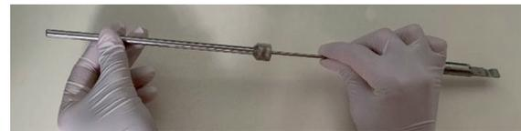
Odvijte čep s kućištem vodilice s gumba s klizačem
