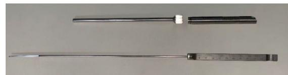
Medidor de profundidad para manguitos desmontado
