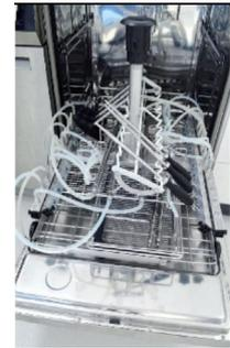
Încărcați tăvile așezând instrumentele pe suporturile dedicate, în conformitate cu marcasele vizibile pe partea inferioară a capacului tăvii.
