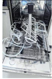
Lataa lokerot ja aseta instrumentit niille tarkoitettuihin kiinnikkeisiin lokeron kannen alapuolella näkyvien merkintöjen mukaisesti. :
