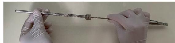
Skruva loss locket med styrhölje från knappen med skjutreglage
