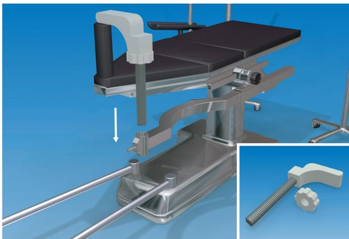
Il martinetto a vite del supporto dell'arto deve essere posizionato completamente entro l'alloggiamento della barra orizzontale con il dado girato in modo che rimanga proprio sotto all'elemento radiotrasparente.
