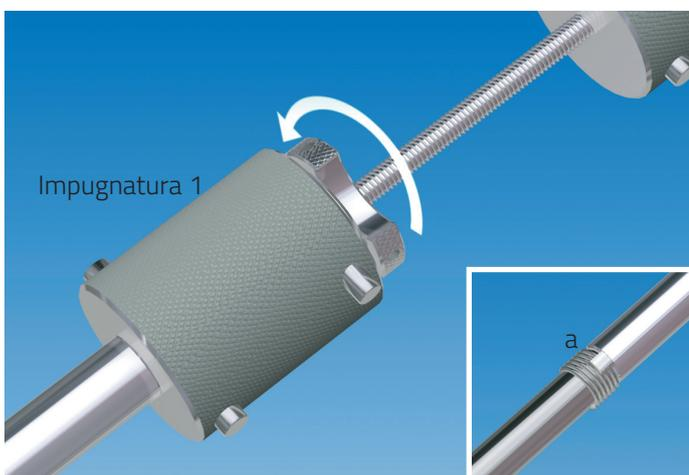
L'impugnatura 1 viene quindi fatta scorrere in avanti fino a che i denti della chiave si trovano nelle tacche (a) della filettatura della parte cilindrica della vite. I denti sono bloccati in posizione ruotando il dado N fino all'impugnatura 1, mantenendone l'allineamento con le tacche. Occorre prestare attenzione a non stringere eccessivamente in quanto l'allineamento potrebbe risentirne.
